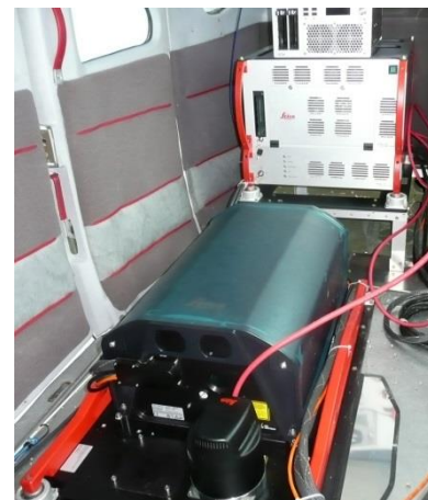
Leica ALS70 LiDAR sensor
