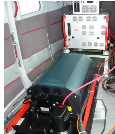
Leica ALS70 LiDAR sensor
